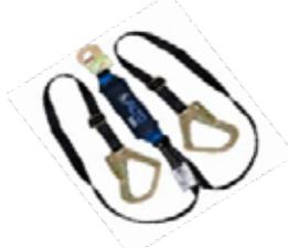
para detención de caídas, sistema graduable hasta los 1.80 metros, posee un mosquetón de 3/4" de apertura en el extremo más próximo al absorbedor, dos terminales en y con mosquetón de 2 1/4" de apertura, fabricado en reata de poliéster de 25.4 mm de ancho.
