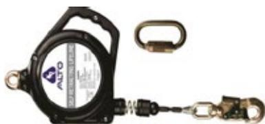
Equipo portátil del sistema contra caídas que provee una línea de seguridad al usuario para desplazarse en un área determinada. Al momento de un evento de caída, la línea auto retráctil activa el mecanismo automático de freno, la cual detiene al trabajador. UNE-EN 360:2002
