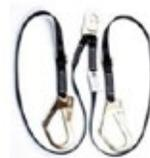
Eslinga en reata regulable hasta los 1.80 metros, posee un mosquetón de 3/4" de apertura en el extremo, dos terminales en y con mosquetón de 2 1/4" de apertura, fabricado en reata de poliéster de 25.4 mm de ancho. **Calidad certificada.**
