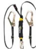
Eslinga en reata regulable hasta los 1.80 metros, posee un mosquetón de 3/4" de apertura en el extremo, dos terminales en y con mosquetón de 2 1/4" de apertura, fabricado en reata de poliéster de 25.4 mm de ancho. **Calidad certificada.**
