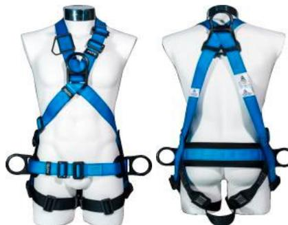
GAMMA Cuerpo entero en "X". Cuenta con un (1) anillo "D" en la zona dorsal para sistemas contra caídas, dos (2) a la altura de la cadera, para sistemas de posicionamiento, y un (1) anclaje frontal de pecho, para tareas de ascenso-descenso. **Calidad certificada.**
