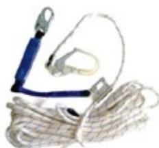
Cuerda trenzada de **50 m** de largo y 16 mm de ancho, extremos con mosquetón estructural de seguridad con refuerzo y un pequeño mosquetón, cuerda con absorbedor, de 28 mm de ancho. CE EN 361 / ANSI Z359.11 (2007).
