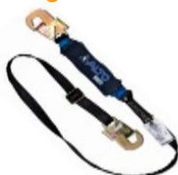
De 25.4 mm de ancho resistente a la tensión, mosquetón de doble seguro de 3/4 en cada uno de sus extremos con resistencia a la tensión de rotura, un sistema de amortiguador de impacto (para ser utilizada en riesgos de caída libre). Longitud de 1.35M A 1,80 metros. **Calidad certificada.**
