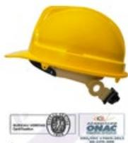
Ajuste tipo cremallera, suspensión de 6 puntos de apoyo textil y banda anti sudor. Sistema universal para ensamble de protector auditivo tipo copa. Con adaptadores para usar barbuquejo de tres o de cuatro apoyos. Cumple con las normas ANSI Z89.1-2014 HECHO EN COLOMBIA - CASCO DE SEGURIDAD INDUSTRIAL TIPO I CLASE E&G. Disponible en colores Blanco Azul Amarillo Naranja Rojo Verde Gris Rosado
