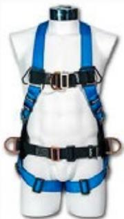
Cuenta con un (1) anillo "D" en la zona dorsal para sistemas contra caídas, dos (2) a la altura de la cadera, para sistemas de posicionamiento, y un (1) anclaje frontal de pecho, para tareas de ascenso-descenso. **Calidad certificada.**
