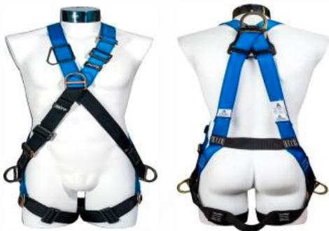
Cuerpo entero en "X". Cuenta con un (1) anillo "D" en la zona dorsal para sistemas contra caídas, dos (2) a la altura de la cadera, para sistemas de posicionamiento, y un (1) anclaje frontal de pecho, para tareas de ascenso-descenso. **Calidad certificada.**
