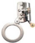
Para soga de 1/2" (13 mm), Diseñado exclusivamente para seguridad en altura, Conocido tambien como salvacaídas o rope grab, Cuerpo completamente en acero inoxidable, Apertura con bisagra para una rapida insercion de la soga, Argolla redonda grande para conexion del gancho o mosqueton, Soporta un peso de: 0.572kg, ANSI Z359.1 / EN353-1/2, 3,600Lbs (16KN)
