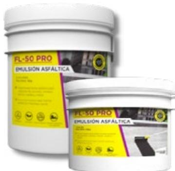
Impermeabilizante asfáltico modificado con polímeros, estabilizado con agentes emulsificantes y llenantes minerales, para cubiertas de concreto, mortero, ladrillo, madera y metal. Puede ser usado para la imprimación bajo mantos asfálticos Fiberglass Isover o como impermeabilizante en frío, en conjunto con refuerzo de fibra de vidrio o poliéster.
