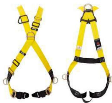
GAMMACuerpo entero en "X". Cuenta con un (1) anillo "D" en la zona dorsal para sistemas contra caídas, dos (2) a la altura de la cadera, para sistemas de posicionamiento, y un (1) anclaje frontal de pecho, para tareas de ascenso-descenso. **Calidad certificada.**
