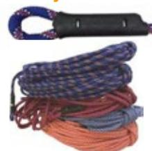
Cuerda por metro, en hilo Poliéster 100% calibres 13mm, con ojáleles, alma y funda, en materiales de alta resistencia a la tensión, abrasión, y bajo desgaste por fricción, resistencia a radiación UV, bajo porcentaje de elongación, punto de fusión superior a 200°C. Producto certificado UNE EN 1891.
